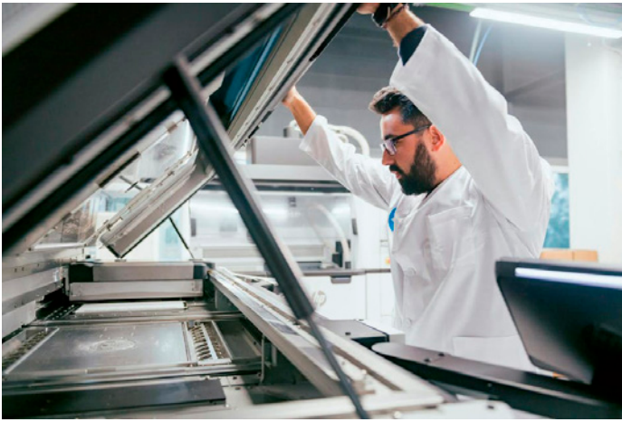
Den här bilden visas under locket på HP Jet Fusion 5200 Series-skrivare, som byggdes speciellt för att möjliggöra produktion i stora volymer.
